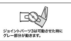
ジョイントパーツ3は可動させた時にグレー部分が動きます。
