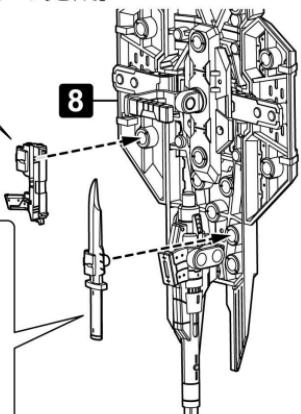
A⑪は接続部分が3.0mm径軸のため、自由に接続が可能です。
