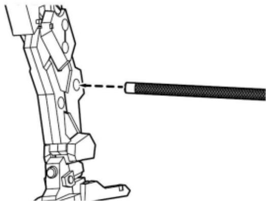
3mm径の接続穴に取り付けることができます。自由に曲げてお使い下さい。
